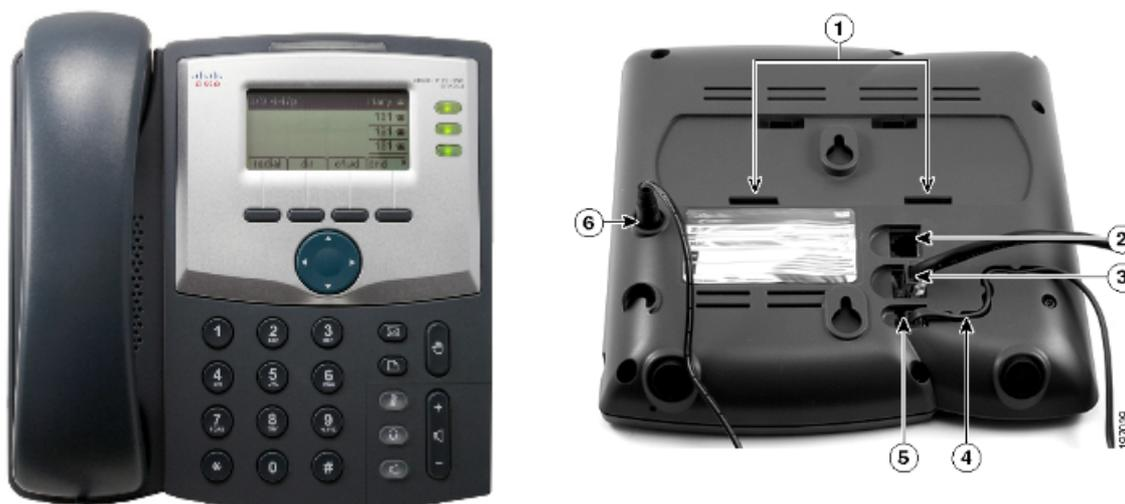
La connexion du téléphone avec le périphérique réseau (routeur ou commutateur) se fait à l'aide du port réseau sur lequel est indiquée l'inscription SW (emplacement n°3).
