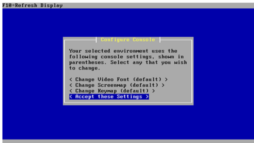
FIGURE I.6 – pfSense-installation : paramétrage de la résolution et du clavier
