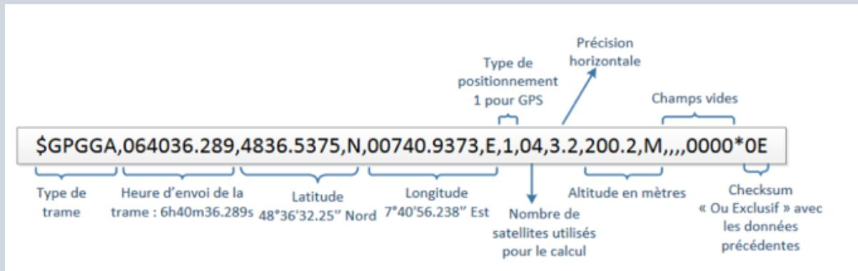
est une **trame GPS de type GGA**. La trame GGA est très courante car elle fait partie de celles qui sont utilisées pour connaître la position courante du récepteur GPS.
