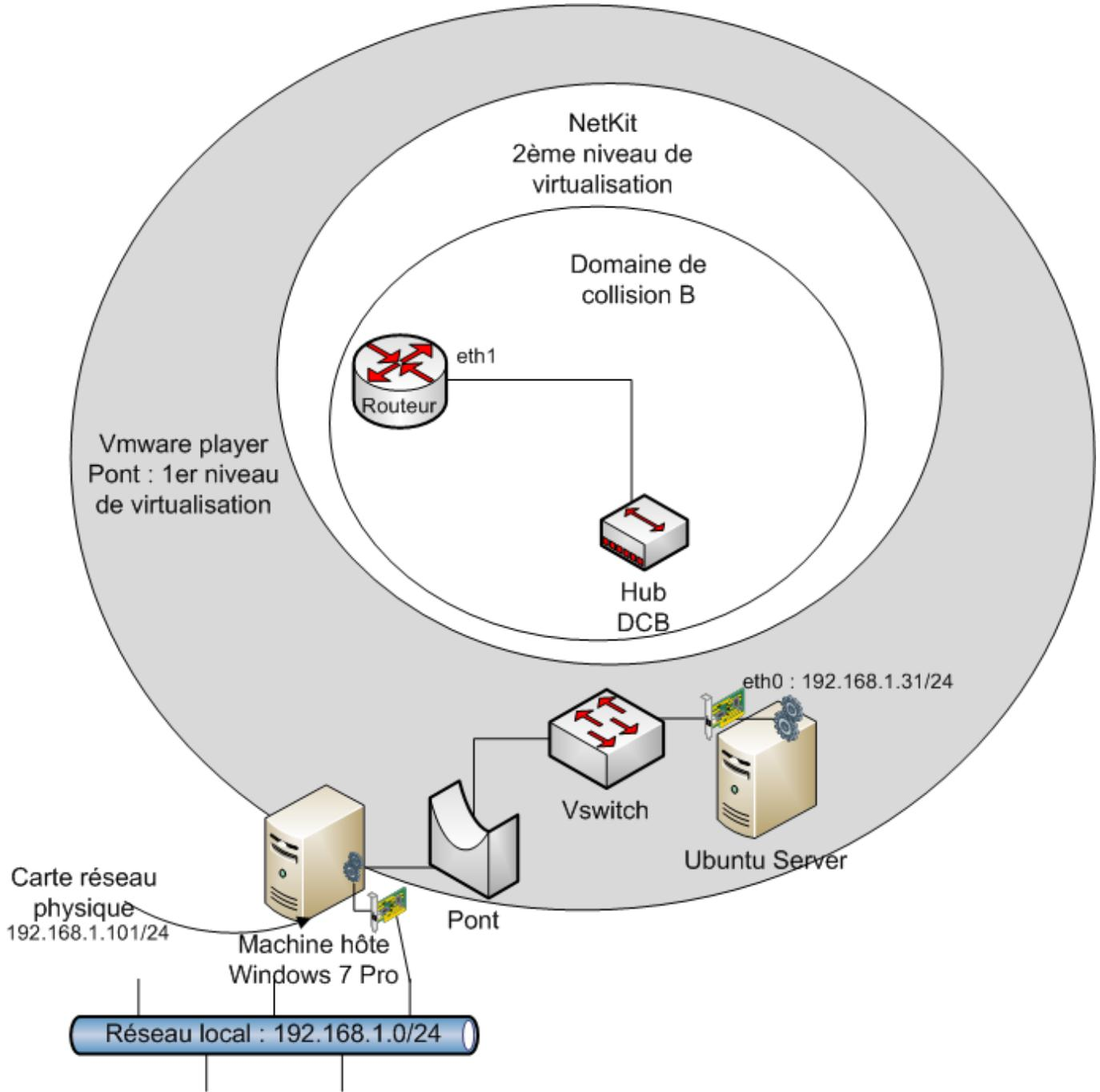
Le routeur va être créé en tant que machine virtuelle, avec une carte réseau eth0 connectée à un domaine de collision appelé **HubDCB**. Prenez la bonne habitude de donner des noms significatifs aux VMs comme aux domaines de collision. Un domaine de collision correspond à un concentrateur.
