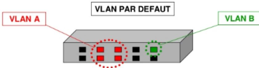
Les premières implémentations ne permettaient pas de créer un même VLAN sur plusieurs commutateurs. Depuis une nouvelle génération de commutateurs permet de réaliser d'un tel VLAN, grâce à l'échange d'informations entre les commutateurs et au marquage des trames. Les VLAN par port manquent de souplesse. Tout déplacement d'une station nécessite une reconfiguration des ports. De plus, toutes les stations reliées sur un port par l'intermédiaire d'un concentrateur, appartiennent au même VLAN.
