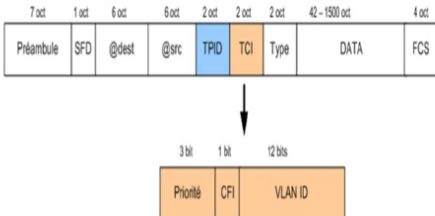
Le champ TPID détermine le type du tag, 0x8100 pour 802.1Q, ce champ est utilisé pour prévoir des évolutions futures afin de pouvoir utiliser le principe du tagging pour différentes fonctionnalités.
