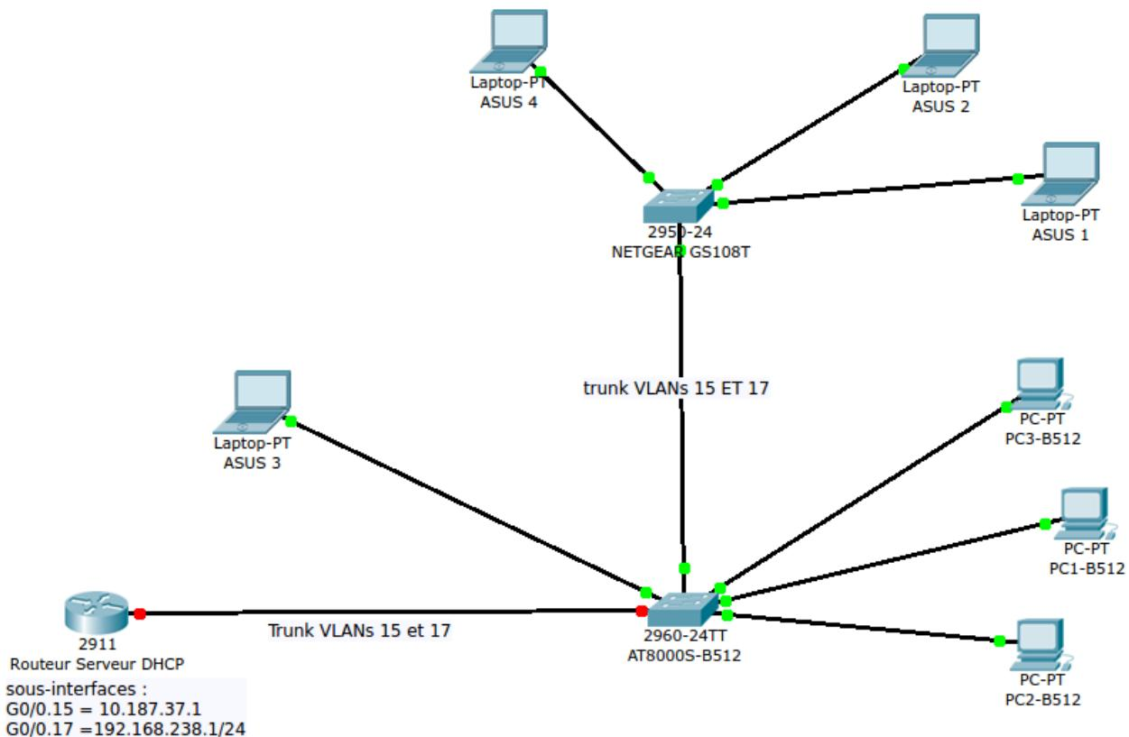
Le routeur sera connecté au switch départemental par une seule interface physique Gigabit G0/0. Il est donc nécessaire de configurer 2 sous-interfaces G0/0.15 et G0/0.17, le débit pratique pour chacune de ces sous-interfaces étant de 500 Mbits/s.
