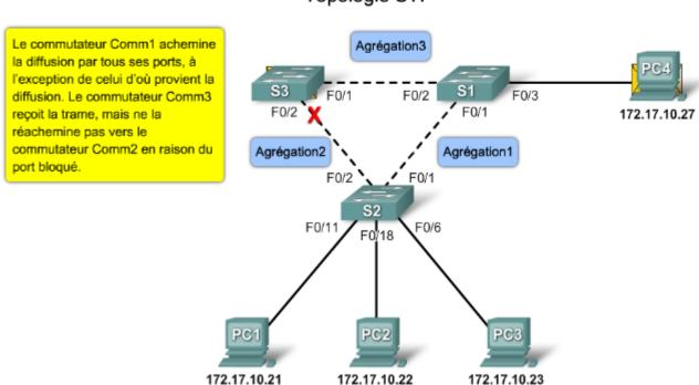
Le protocole STP, lorsqu'il est activé, invalide un port sur la boucle. STP va réactiver automatiquement le port bloqué en cas de panne d'un lien actif et va donc compenser la panne.
