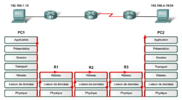
Les flèches rouges représentent le flux traversant les couches OSI.
