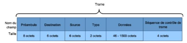
Préambule : utilisé pour la synchronisation ; contient également un délimiteur pour marquer la fin des informations de synchronisation.
