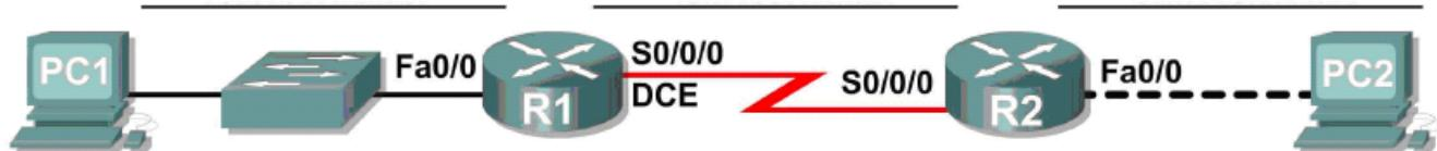
Dans cet exemple, La liaison entre le routeur R1 et le routeur R2 est de type série DCE avec une fréquence d'horloge de 64 000.
