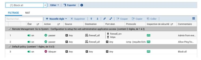
Les firewalls SNS utilisent la technologie **SPI (Stateful Packet Inspection)** qui leur permet de garder en mémoire l'état des connexions TCP et des pseudo-connexions UDP et ICMP afin d'en assurer le suivi et de détecter d'éventuelles anomalies ou attaques.
