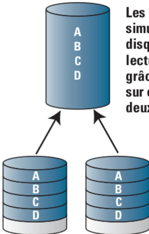
**Les données sont écrites simultanément sur les deux disques. Les requêtes de lecture peuvent être satisfaites grâce à la lecture des données sur chaque disque ou sur les deux disques.**
