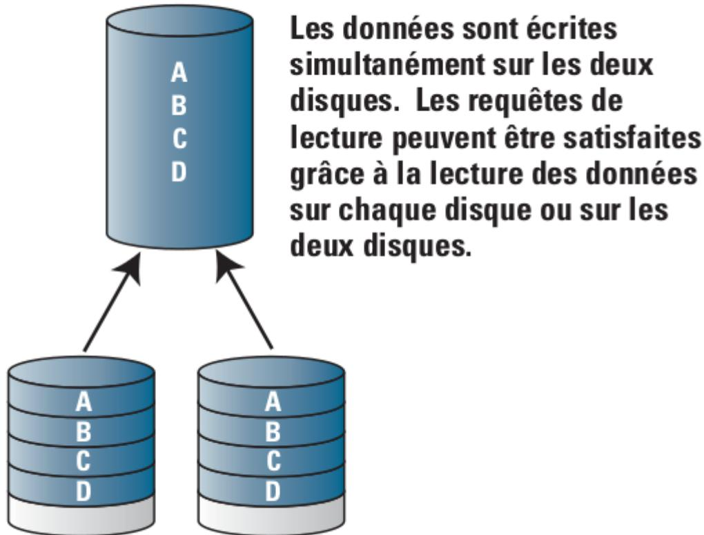
**Les données sont écrites simultanément sur les deux disques. Les requêtes de lecture peuvent être satisfaites grâce à la lecture des données sur chaque disque ou sur les deux disques.**
