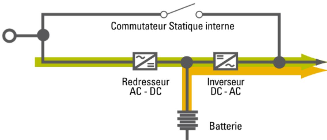
Avantage : technologie la plus performante, application constamment protégée contre tout type de perturbation, régulation permanente de la tension de sortie (amplitude et fréquence), continuité de service grâce au by-pass.
