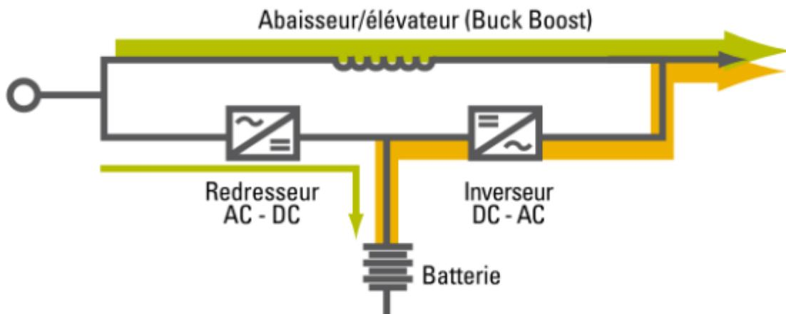
Avantage : pallie les baisses ou les hausses de tension prolongées sans solliciter les batteries.
